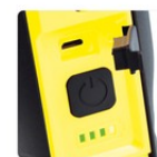
Micro-USB Ladeanschluss und Kapazitätsanzeige
