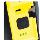
Micro-USB Ladeanschluss und Kapazitätsanzeige
