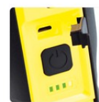
Micro-USB Ladeanschluss und Kapazitätsanzeige
